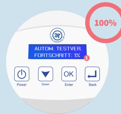
**5** **Warten** Sie bis der Testvorgang bei **100%** ist. Das **Ergebnis** wird Ihnen nun im **Display** angezeigt.
