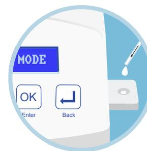
**6** Nehmen Sie einen **Teststreifen** und führen diesen in das **IRIS-Gerät** ein. Geben Sie, wie auf Seite 5 beschrieben, Milch in die **Probeneingabe**.
