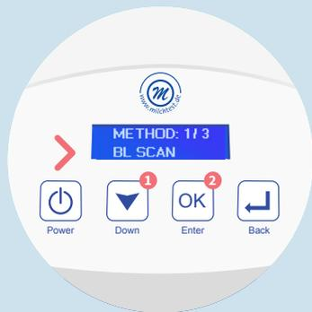
**2** Wählen Sie mit der **Pfeiltaste** die **Duplex BT Scan oder Beta Scan** Methode für den Test aus.
