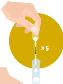
**4** Verwenden Sie eine **saubere Pipette** und entnehmen Sie die Milchprobe **vom Boden** des Sammelbehälters.
