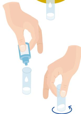
**5** Drücken Sie die Pipette, um **5 Tropfen** der Milchprobe in das **Teströhrchen** aus dem Set zu füllen. Geben Sie nicht mehr Tropfen hinein. Werfen Sie die Pipette weg.
